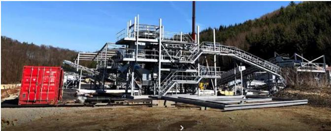
Im vergangenen Jahr wurde im gewohnten Rahmen der ordentliche Betrieb sichergestellt. Die im Jahr 2020 installierte, stationäre Schlackentrennanlage auf dem Boden der Bürgergemeinde ist im Vollbetrieb. Mit dieser Anlage werden wertvolle Metalle aus der angelieferten Schlacke getrennt. Der Rest wird vor Ort ordentlich deponiert.
