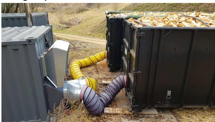
Trocknungsanlage mit Warmluftschlauch zum Container
